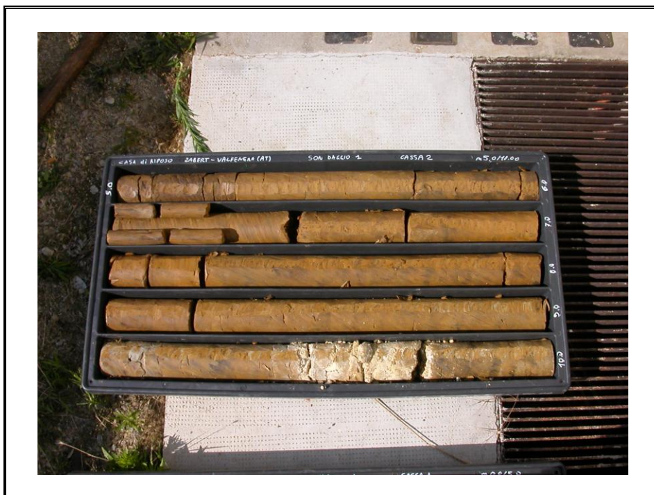
Foto 2: Sondaggio S1 - cassa 2 - da 5.00 m a 10.00 m.
